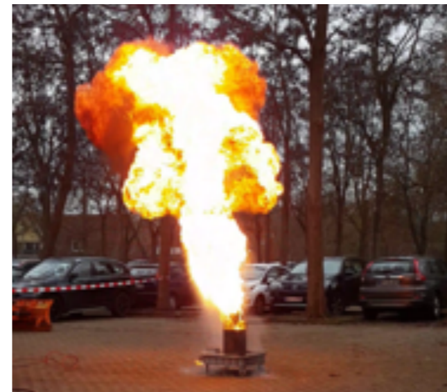
Zwei Stichflammen bei einem Fettbrand, der versucht wurde mit Wasser zu löschen.
