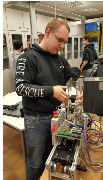
Anschließend machten sich die Auszubildenden an die Stationsarbeit, welche sowohl die (Um-) Programmierung des bestehenden Automatisierungsprogramms beinhaltete als auch die hardwaretechnische Erweiterung um zusätzlich benötigte Bauelemente wie Sensoren oder pneumatische Aktoren (Zylinder, Ventile).
